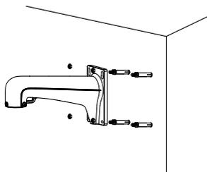
Рисунок 2-4 Установка кронштейна
