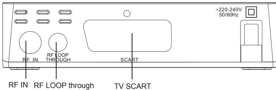
**RF IN** – Выход для подключения RF-модулятора
