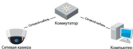
Рисунок 3-2 Соединение через коммутатор или роутер
